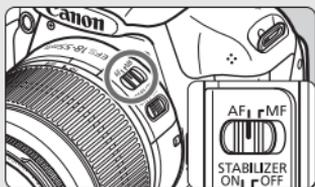
**Set the lens focus mode switch to <AF>.** (p.29)
